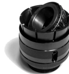
Alternativ zur Hydraulik kann auch eine Spindel eingesetzt werden. Das Werkzeug wird dadurch auch bei Pannendiensten und Reparaturen unterwegs einsetzbar. Die Abzugsvorrichtung ist Teil eines vielseitigen Baukastensystems. Adaptierungen zu verschiedenen Spindeln und Hydraulikzylindern, sowie Hülsen zur Überbrückung längerer Wellen erweitern das Einsatzgebiet.
